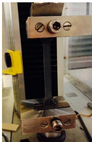
Mesures mécaniques sur une éprouvette imprimée 3D ISO 1A - ISO 527-2. Paramètres d'impression: 100% de remplissage dans l'axe (0°).
